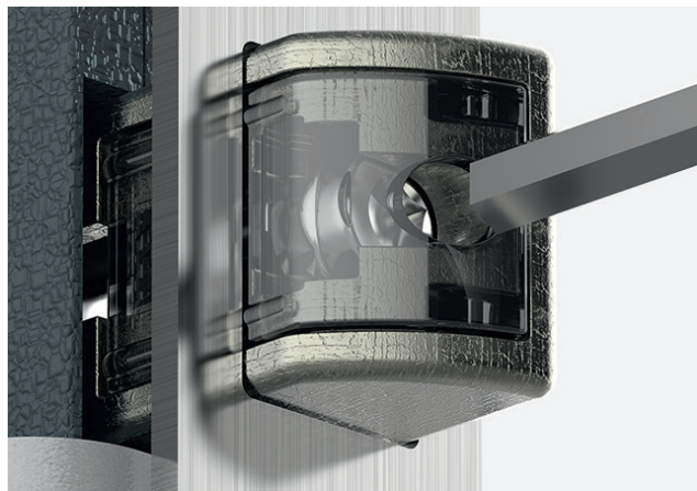
Deux en un : l'unique vis imperdable, placée au centre du pêne assure son réglage et son maintien en position.
